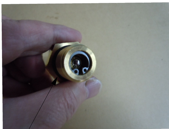
吸水ニップル内の弁球
