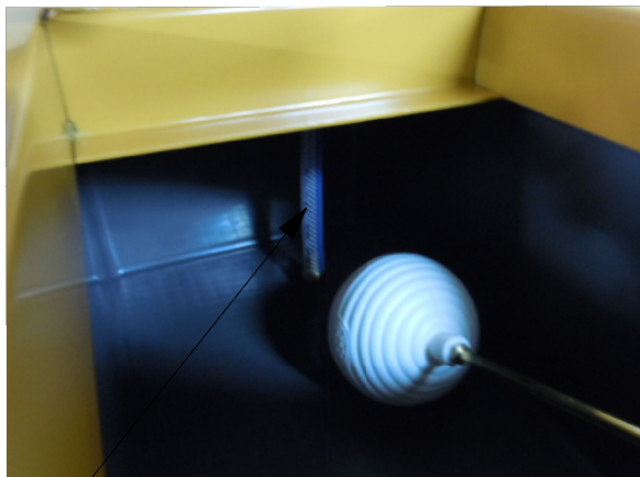
吸水管を吸水ニップルから取り外す
